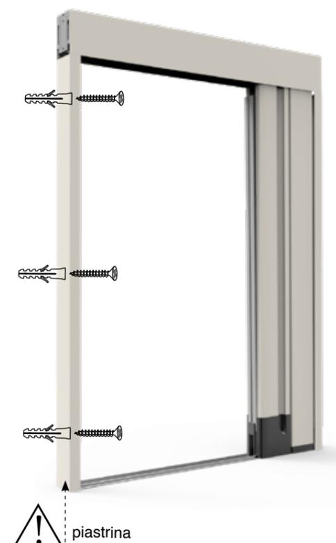
**8** Posizione guida superiore a livello e serraggio terminale
