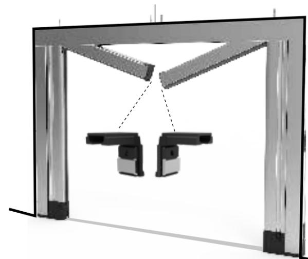
**5** Posizionamento guida superiore a livello e serraggio terminale
