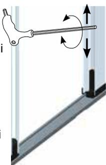
**F** Se necessario effettuare la regolazione dei singoli cordini operando direttamente sui regoli cordino posti nel dorso a muro
