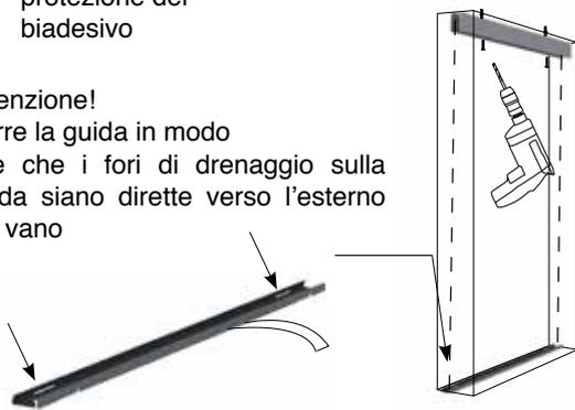
**B** Posizionare all'interno delle guide i profili a muro (3) e fissarli sui due lati del vano
