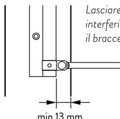
Lasciare uno spazio (minimo 13mm) per non interferire con l'apertura della porta quando il braccetto si trova in posizione OFF.
