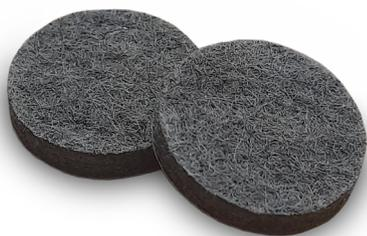
Distanziale disponibili in diversi spessori 2,5 mm, 4mm e 5,5 mm con diametro di 20mm in fibra di poliestere ad alta densità, impedisce la deformazione del telaio porta durante l'espansione dell'adesivo schiumogeno.
