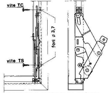
Eseguire le forature ed avvitare la KLEMDUE sul telaio fisso.
